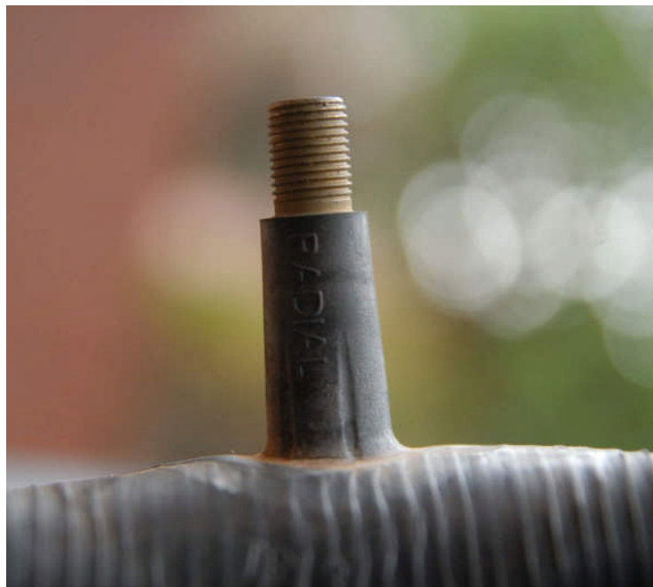
TR13 tubeless valve stem
